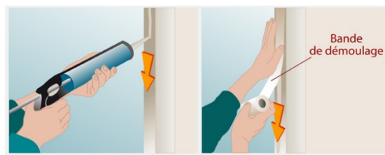
Figure 3: Pose d'un joint de silicone
